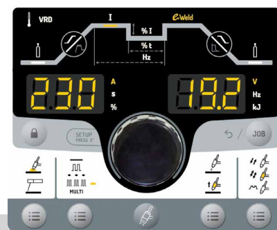
Interfejs użytkownika z podwójnym wyświetlaczem z pokrętłem i przyciskiem do szybkiego ustawiania parametrów
